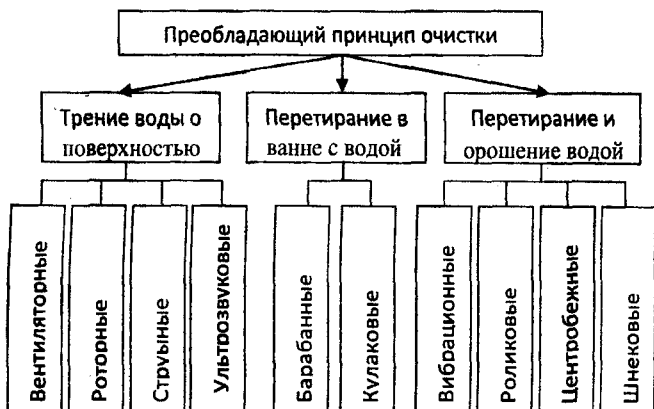
Рис. 1. Классификация моечных машин и устройств по принципу очистки продукта от загрязнений
