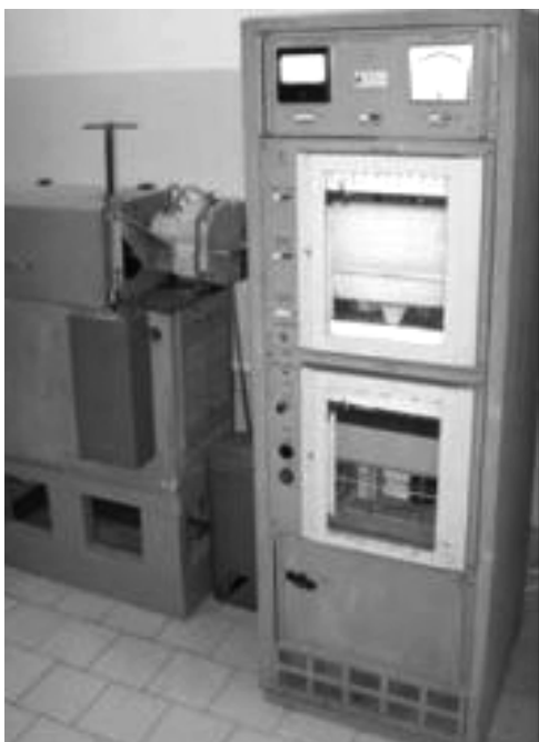
Рисунок 4.18. – Фотография машины для испытаний материалов на трение и износ модели 2070 СМТ-1
