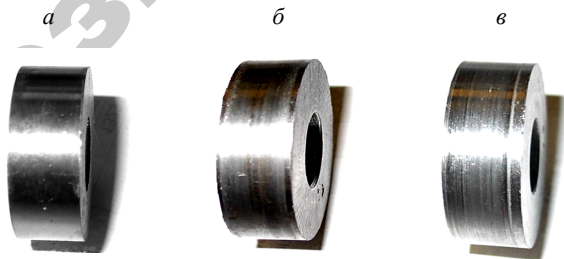
а – до начала испытаний; б – после приработки с конртрелом; в – после окончания испытаний
