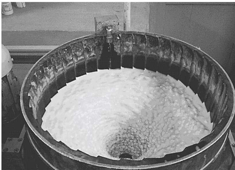
Рисунок 1.6. – Фотография рабочей зоны при объемной центробежно-ротационной обработке
