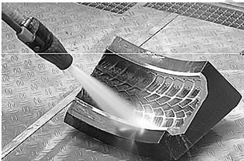
Рисунок 1.7. – Фотография рабочей зоны при струйно-абразивной обработке
