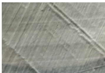
Рисунок 4.8.– Форма стружек ( a ) и следы микрорезания ( б ) после MAO
