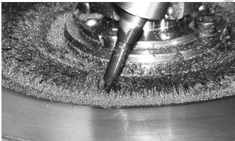
Рисунок 1.12. – Фотография рабочей зоны при магнитно-абразивной обработке
