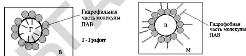
Рис. 34. Стабилизация суспензии
