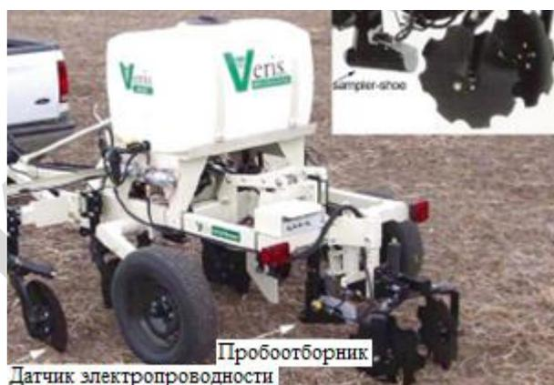
Рисунок 2.30 - Оборудование Veris для одновременного контроля рН и электропроводности почвы
