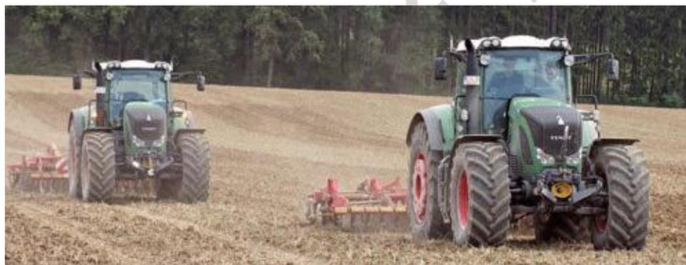
Рисунок 2.12 - Синхронизация работы тракторов с помощью системы Guide Connect
