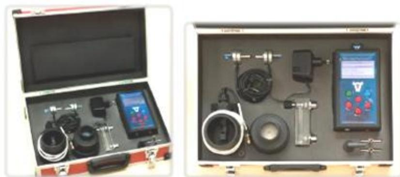
Рисунок 4.4 - Общий вид комплекта приборов для контроля технических параметров молочно-доильного оборудования
