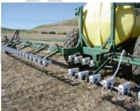
Рисунок 2.22 - Консоль разбрызгивателя с оптическими сенсорами для капельного опрыскивания сорняков на невозделанном поле
