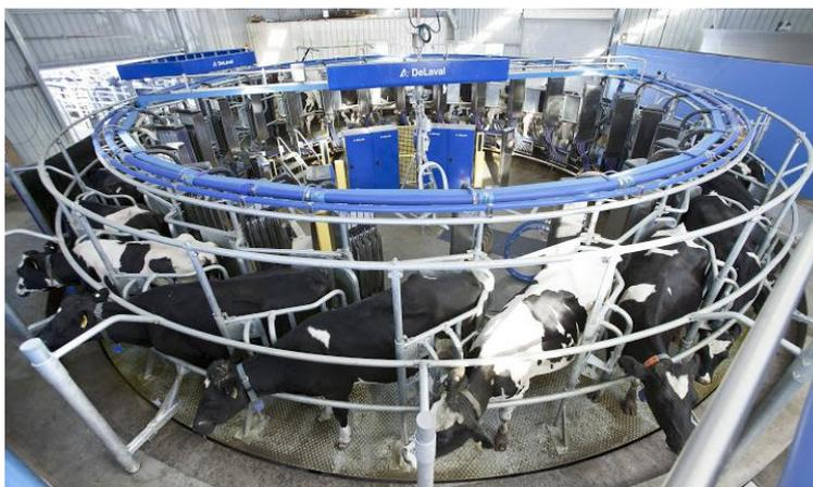
Рисунок 3.14 - Роботизированная доильная «карусель» AMR
