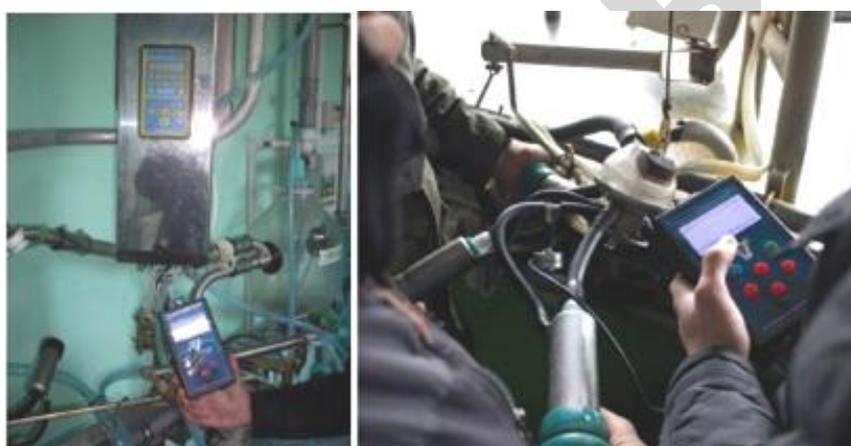
Рисунок. 4.5 - Применение комплекта приборов для контроля технических параметров молочно-доильного оборудования.
