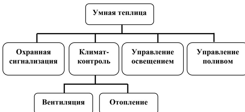
Рисунок 2.56 - Блок-схема системы «умная теплица»
