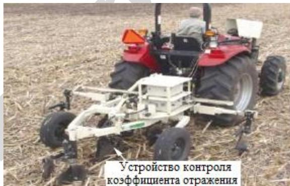
Рисунок 2.21 - Одновременное картирование коэффициентов отражения излучения ближней инфракрасной части спектра в нижней части культиватора и электропроводностей контактным методом
