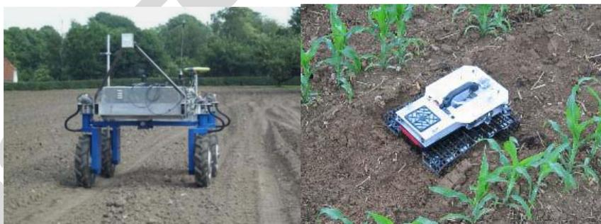
Рисунок 2.40 - Портальная платформа для автоматизированного контроля состояния растений (Датский технический университет) (слева); робот, расположенный ниже уровня растительного покрова (Гогенгеймский университет, Германия) (справа)
