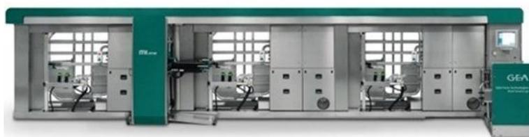
Рисунок 3.13 - Многобоксовый доильный робот Mlone
