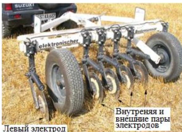
Рисунок 2.19 - Измерение электропроводности почвы контактным методом, система Veris. Правый токовый электрод скрыт за колесом
