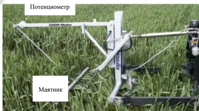
Рисунок 2.33 - Контроль сопротивления покрова злаковых культур изгибам с помощью маятника, который установлен перед трактором
