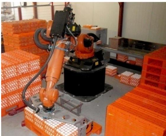
Рисунок 3.24 - Робот-штаблер Cobot для загрузки яиц в лотки
