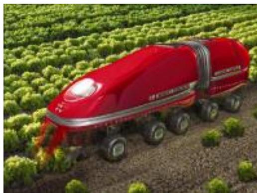
Рисунок 2.50 - Робот для выборочной уборки урожая фирмы Massey Ferguson
