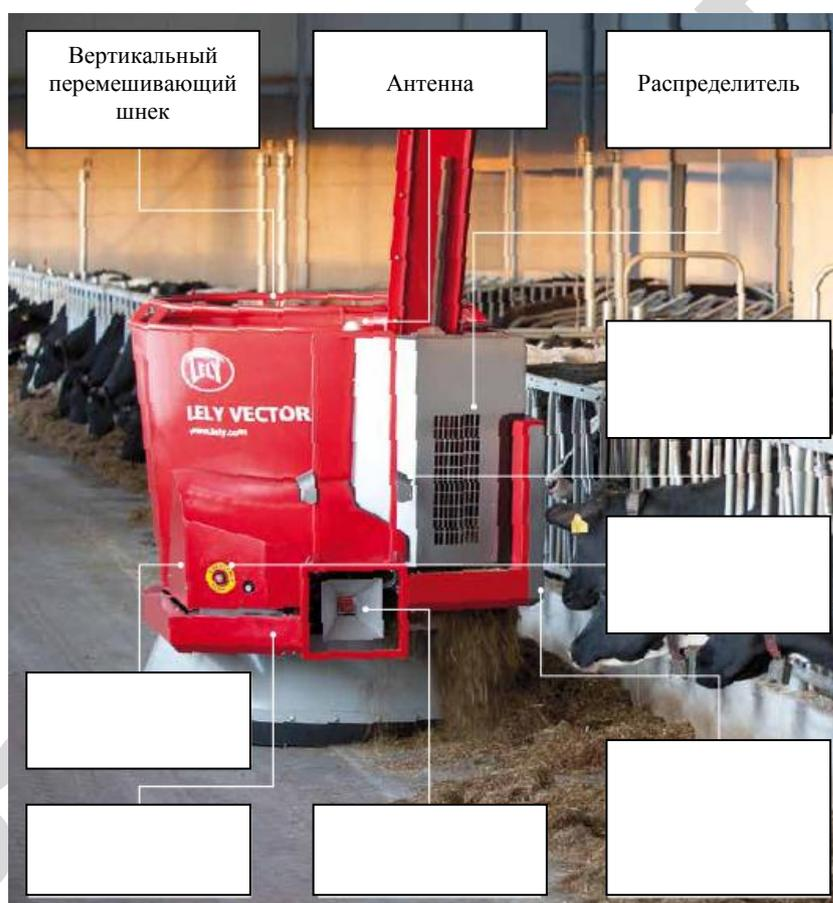
Рисунок 3.7 - Роботизированная система смешивания и подачи корма Vector
