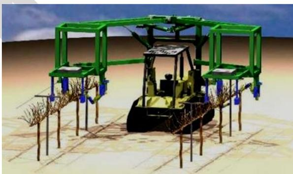
Рисунок 2.47 - Робот для обрезки виноградной лозы фирмы Vision Robotics
