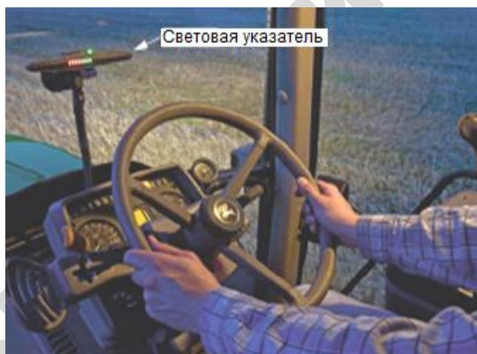
Рисунок 2.7 - Ручное управление машиной с помощью световой указатель
