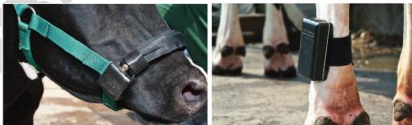
Рисунок 3.1 - Система мониторинга состояния здоровья коров RumiWatch: сенсор жевательных движений (слева) и сенсор-шагомер
