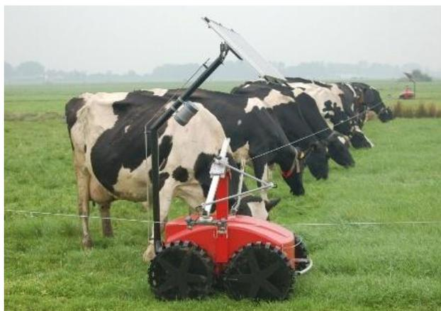
Рисунок 3.10 - Робот-пастух автоматической пастбищной системы Voyager
