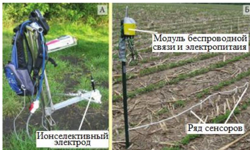
Рисунок 2.16 - Оборудование для точечных измерений рН почвы с использованием ручного зонда (а) и точечного мониторинга матричного потенциала почвенной влаги и температуры почвы (б)
