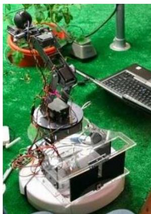
Рисунок 2.59 - Многофункциональный робот для выращивания помидоров (Массачусетский технологический институт)
