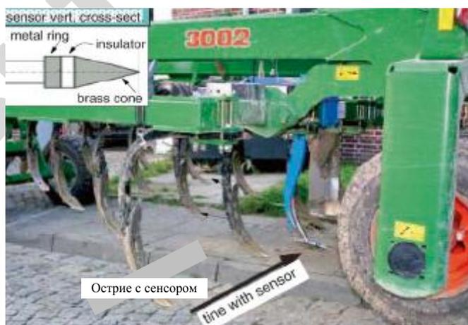
Рисунок 2.28 - Схема емкостного контроля на кончике зуба культиватора.
