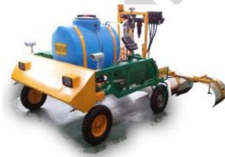
Рисунок 2.46 - Роботизированный опрыскиватель для низкорастущих ягодных культур
