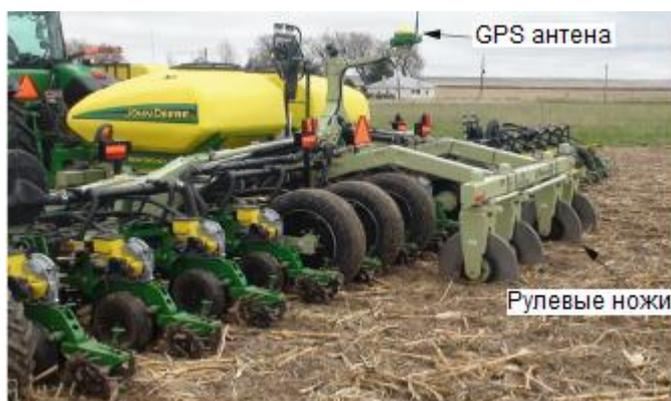
Рисунок 2.13 - Активное управление сеялкой на боковом откосе.
