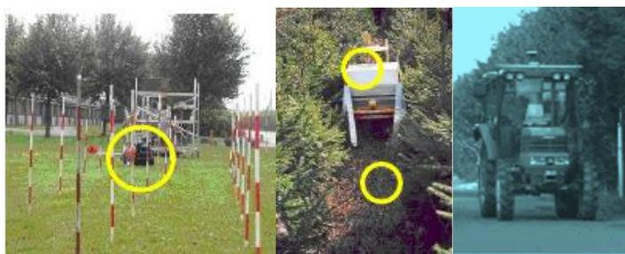
Рисунок 2.44 - Робот картирует модельные деревья (слева); робот-пропольщик срезает траву под елками (в центре); роботизированный трактор сканирует зрелые деревья (справа)
