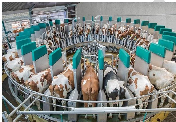
Рисунок 3.15 - Роботизированная «карусель» DairyProQ
