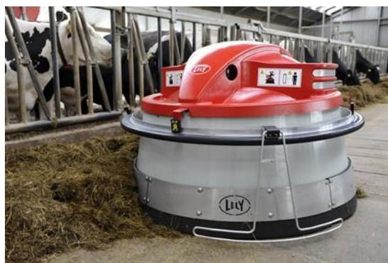
Рисунок 3.8 - Подравнивание кормов в коровнике с помощью робота Juno
