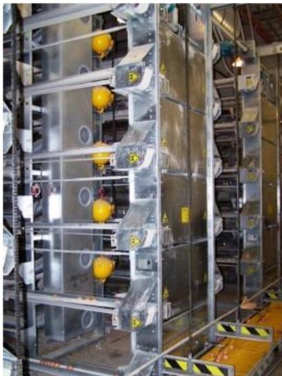
Рисунок 3.22 - Роботизированная шестиуровневая установка с лифтовой системой для сбора яиц
