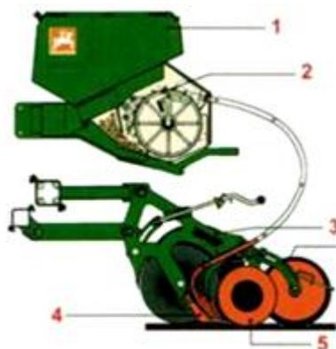
Рисунок. 2.25 - Сеялка EDX 6000-Т с системой высева и заделки семян Хресс фирмы Amazon
