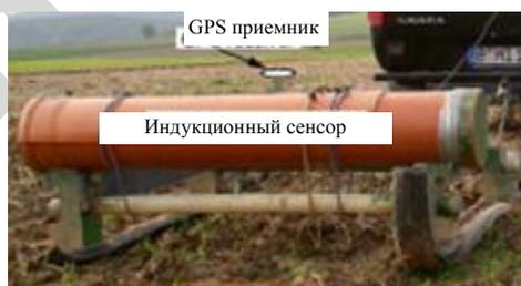
Рисунок 2.20 - Измерение электропроводности почвы с помощью электромагнитной индукции в режиме реального времени в процессе движения
