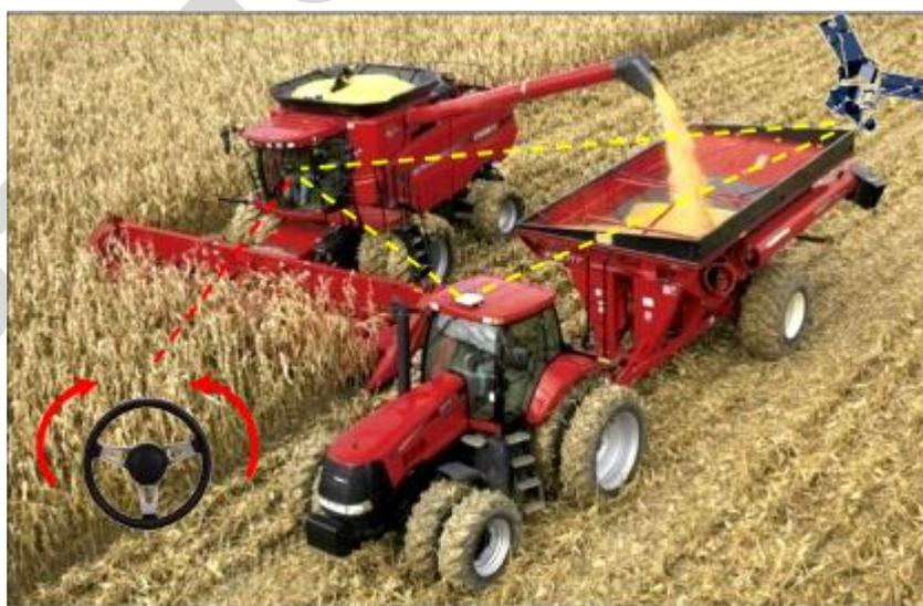
Рисунок 2.11 - Синхронизация работы машин с помощью системы V2V
