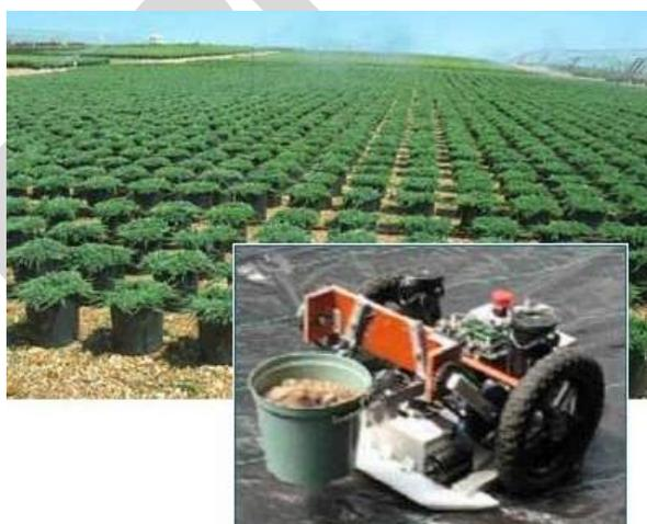
Рисунок 2.38 - Робот фирмы Q Robotics для высадки рассады в горшках
