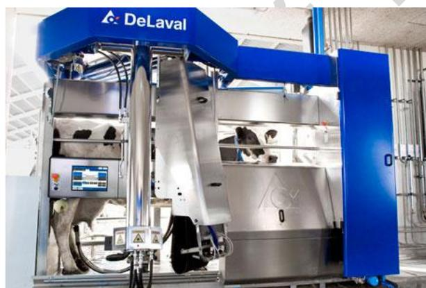
Рисунок 3.20 - Доильный робот VMS
