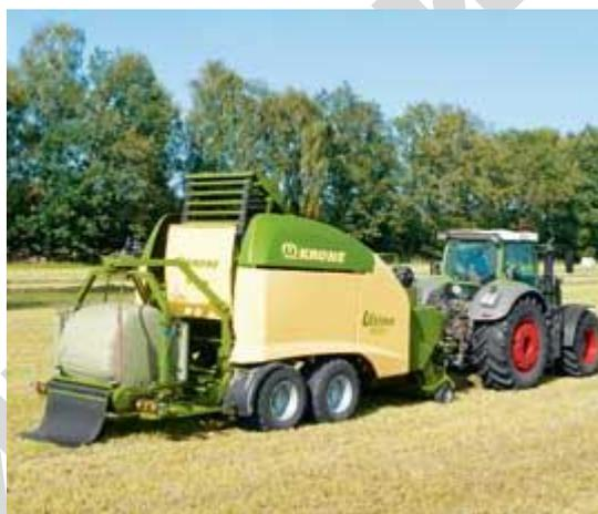
Рисунок 2.5 - Пресс-подборщик-обмотчик Ultima Non-Stop
