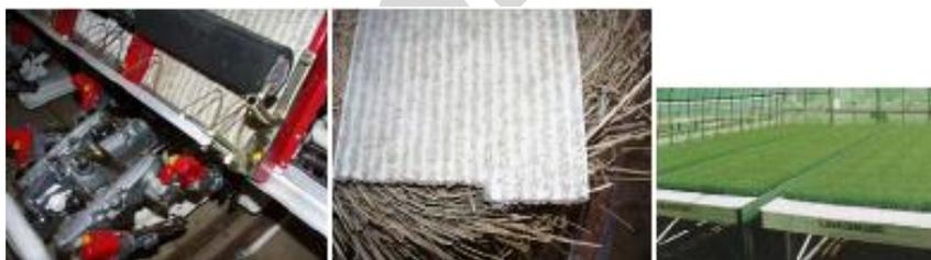
Рисунок 2.39 - Посевное (посадочное) устройство, приспособленное для работы с посевными (посадочными) матами (слева); посевной мат с рисовыми зернами и удобрениями, внедренными в перфокарту мата (в центре); рисовая рассада, готовая для пересаживания (справа)
