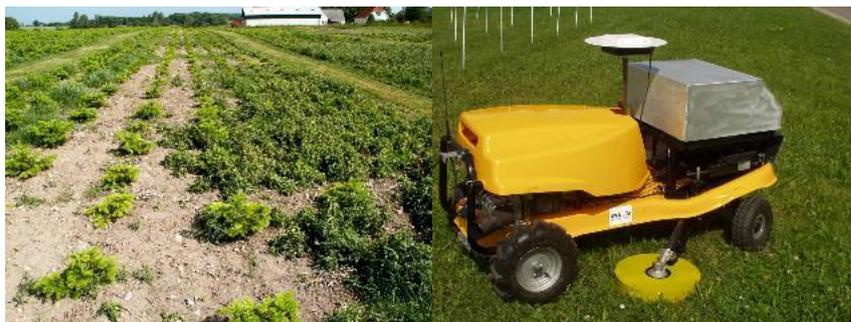
Рисунок 2.43 - Молодые новогодние елочки с фрагментами сорняков (слева). Автономный пропольщик новогодних елок, оснащенный боковым резаком и системой управления на основе GPS (справа)
