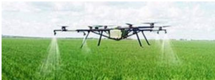
Рисунок 2.52 - Опыление посевов с помощью беспилотного летательного аппарата
