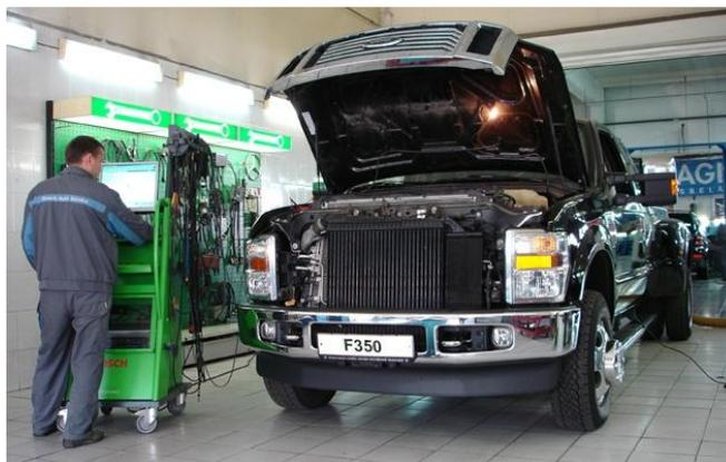
Рисунок 4.6 - Компьютерная диагностика двигателя в сервисном центре
