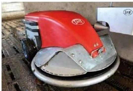
Рисунок 3.17 - Навозоуборочный робот Discovery
