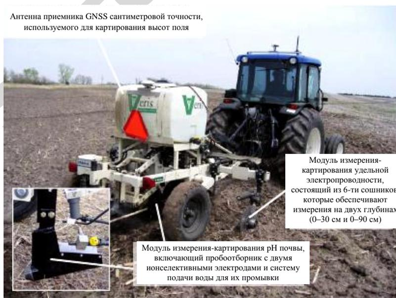
Рисунок 2.18 - Передвижная сенсорная платформа Veris с блоками измерения-картирования удельной электропроводности и рН почвы, оборудованная приемником спутниковой навигационной системы Trimble AgGPS 442
