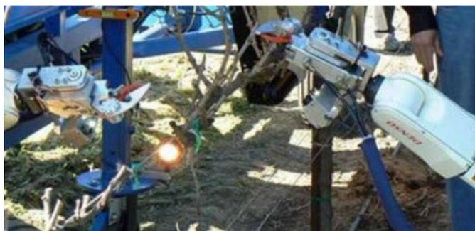
Рисунок 2.48 - Процесс роботизированной обрезки виноградной лозы выдвижными ножницами
