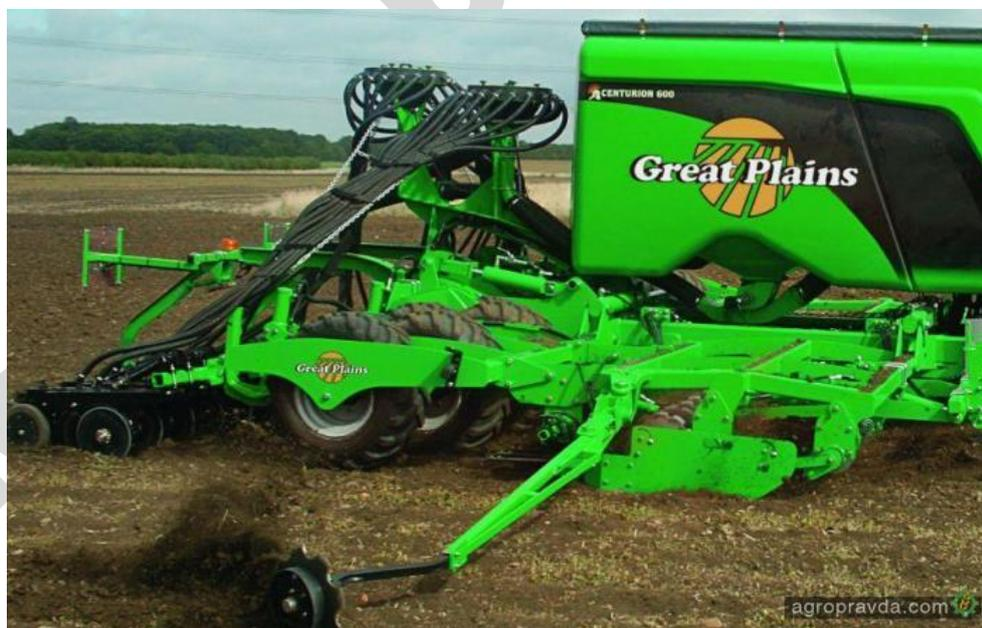
Рисунок 2.26 - Сеялка Centurion-600 с системой регулировки заглубления культиваторных дисков
