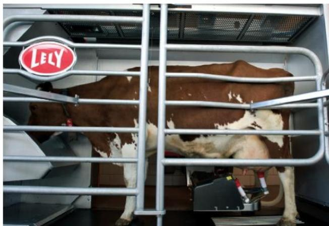
Рисунок 3.12 - Доильный бокс робота Astronaut A4
