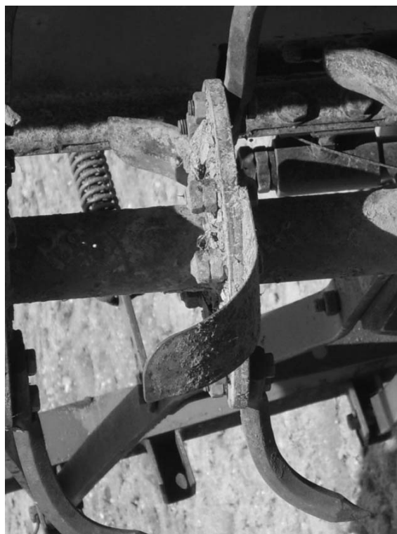
Рис. 2. Комбинированный рабочий орган пальцево-ножевого типа для фрез с горизонтальной осью вращения
