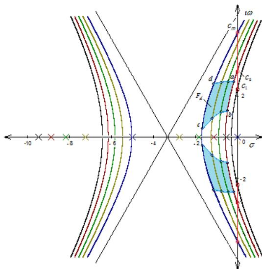
Рисунок 1 – Поле корневых траекторий полинома  $s^3 + 10s^2 + a_2s + a_3 = p(s)$  при  $a_2 \in [5, 25]$ ,  $a_3 \in [-\infty, +\infty]$  и доминирующее поле  $F_d = abcd$  устойчивое при  $a_2 \in [10, 25]$ ,  $a_3 \in [70, 20]$
