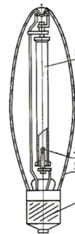
Рис. 3.27. Устройство лампы ДНаТ: 1 — колба из термостойкого стекла; 2 — керамическая газоразрядная трубка; 3 — вольфрамовый электрод; 4 — цоколь
