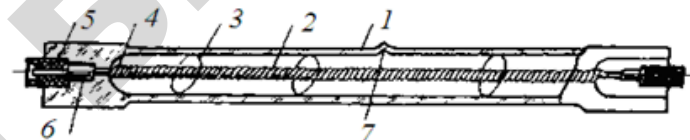
Рис. 3.7. Конструкция трубчатой кварцевой галогенной лампы накаливания: 1 — трубчатая колба из кварцевого стекла; 2 — тело накала из вольфрамовой спирали; 3 — держатели тела накала; 4 — электроды; 5 — токоподводы; 6 — молибденовая фольга; 7 — штенгель
