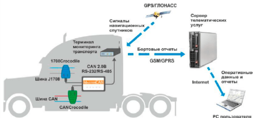
Рисунок 3 – Схематическое представление процесса передачи данных телеметрии большегрузной техники на компьютер пользователя
