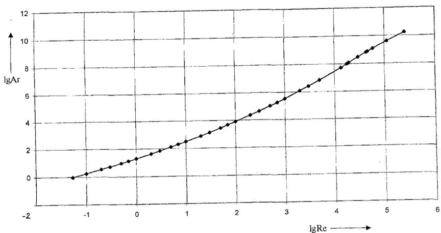
Рис. 4. Зависимость  $Ar = f(Re)$  при свободном равномерном падении шаров в вязких средах
