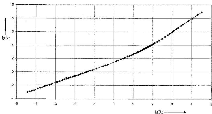
Рис. 5. Зависимость  $Ar = f(Re)$  при свободном равномерном падении частиц кварцевого песка в воде
