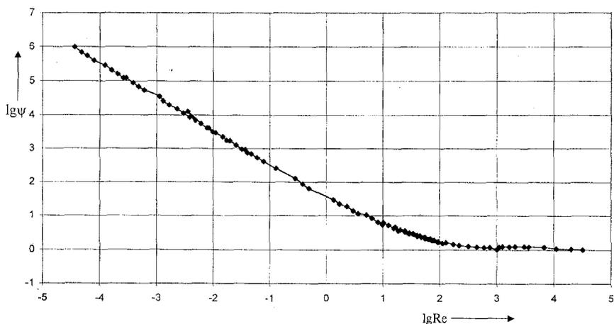
Рис. 2. Зависимость  $\psi = f(\text{Re})$  при свободном равномерном падении частиц кварцевого песка (естественных наносов) в воде
