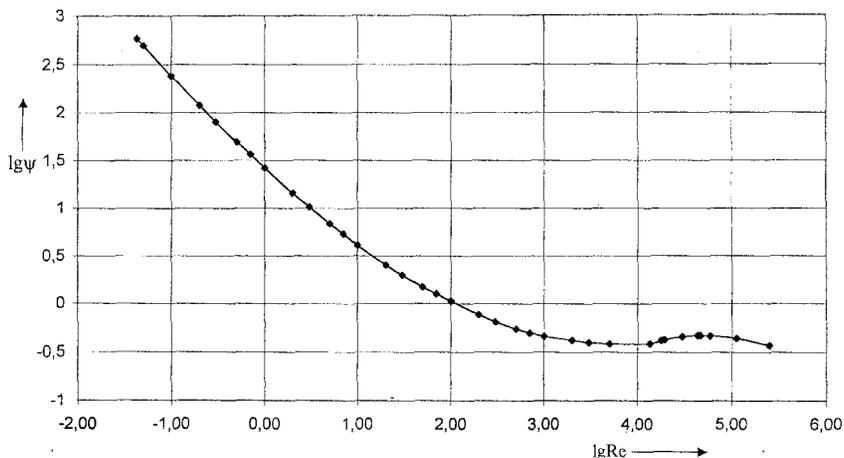
Рис. 1. Зависимость  $\lg \psi = f(\text{Re})$  при свободном равномерном падении шаров в вязких средах
