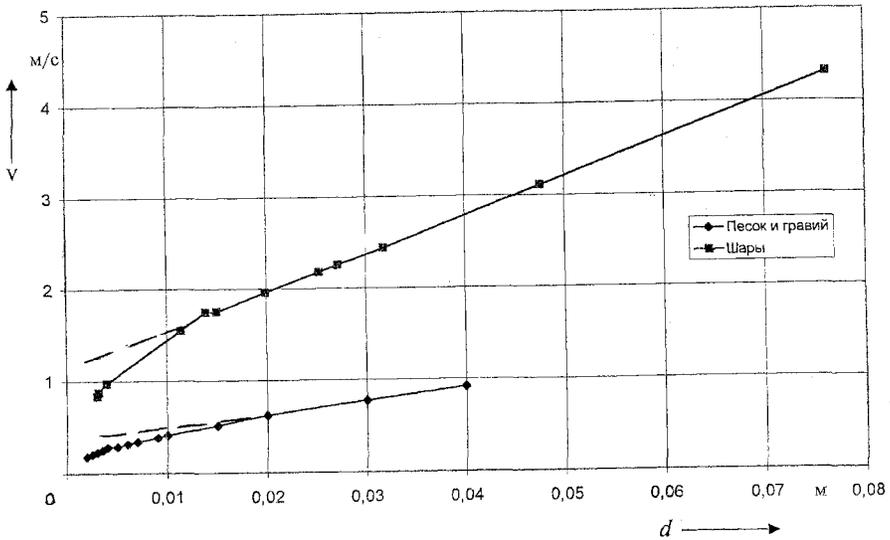
Рис. 3. Зависимость  $v = f(d)$  при свободном равномерном падении шаров и частиц кварцевого песка и гравия в воде
