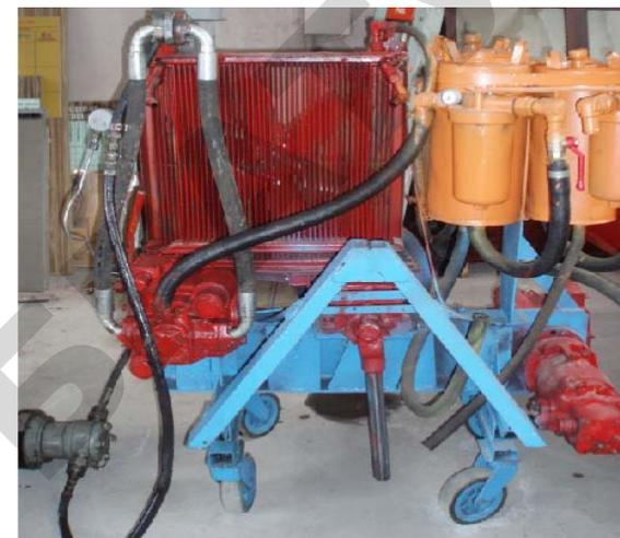
Рис. 3.70. Обкаточно-диагностическое устройство
