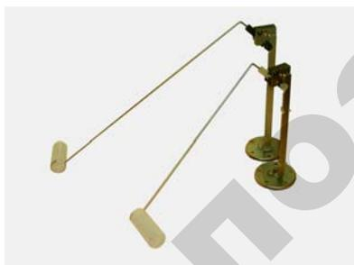
Рис. 2.45. Датчик уровня топлива
