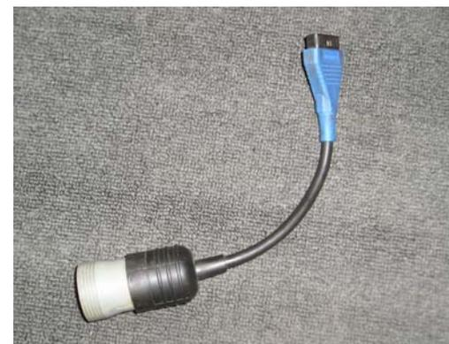
Рис. 2.27. 6-контактный кабель-переходник для диагностического прибора Pro-Link 9000 (н/к 404024)
