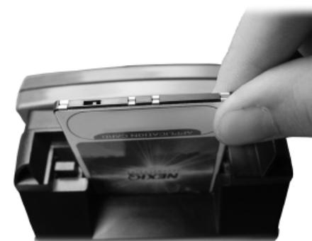
Рис. 2.35. Установка электронной карточки для многопротокольного картриджа
