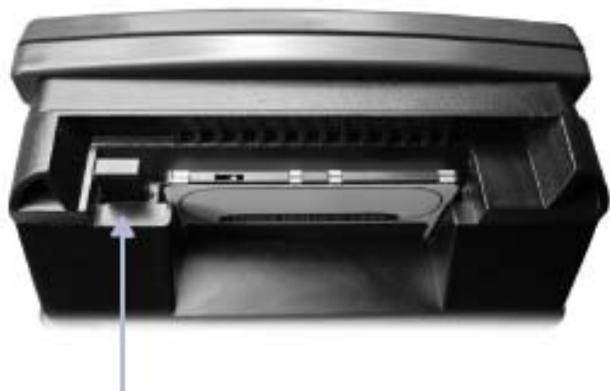
Рис. 2.36. Извлечение электронной карточки для многопротокольного картриджа
