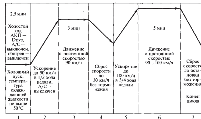
Рисунок 5.11 — Ездовой цикл и компоненты, которые при этом активируются (адсорбер паров топлива и коррекция подачи топлива проверяются на всех режимах): 1 — подогрев лямбда-зонда, пропусков воспламенения смеси, массового расхода топлива; 2 — пропуски воспламенения смеси; 3 — пропуски воспламенения смеси, рециркуляции отработавших газов, массового расхода топлива, подогрева лямбда-зонда; 4 — рециркуляция отработавших газов; 5 — пропуски воспламенения смеси; 6 — катализатор, пропуски воспламенения смеси; 7 — рециркуляция отработавших газов; АКП — автоматическая коробка передач
