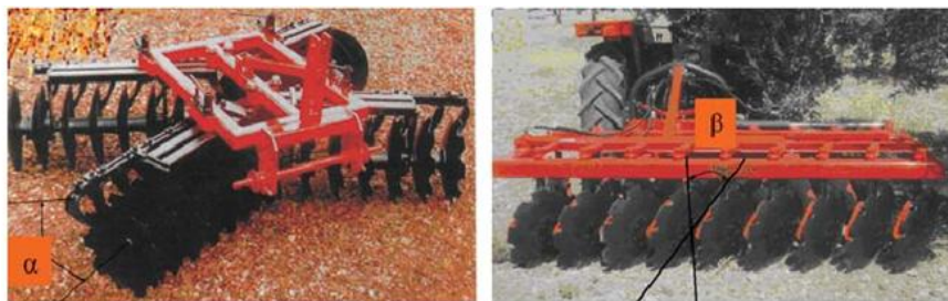
а) угол \alpha – угол атаки дисков; б) угол \beta – угол установки диска в продольно-вертикальной плоскости
