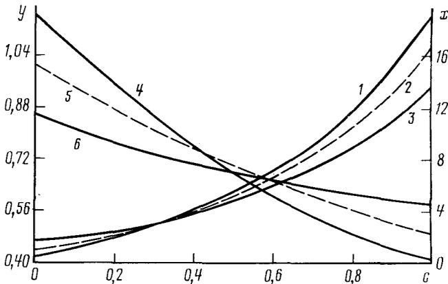
Рис. 1. Зависимости безразмерных упругих коэффициентов  $x = K_0 K_1^{-1}$ ,  $y = \mu_0 \mu_1^{-1}$  от концентрации наполнителя  $c = c_2$
