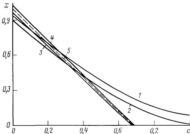
Рис. 3. Зависимость безразмерного коэффициента теплопроводности (электропроводности)  $x = \lambda_0 \lambda_1^{-1}$  пористой среды от концентрации пор  $c = c_2$
