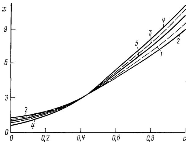
Рис. 2. Зависимость безразмерного коэффициента теплопроводности (электропроводности)  $x = \lambda_0 \lambda_1^{-1}$  от концентрации наполнителя  $c = c_2$
