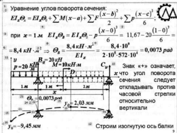
Рисунок 1 – Последовательность эффектов анимации при определении углов поворота сечений методом начальных параметров
