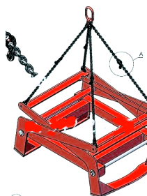
Рисунок 3 – Захват клешевой ЗКРН-3,0 т
