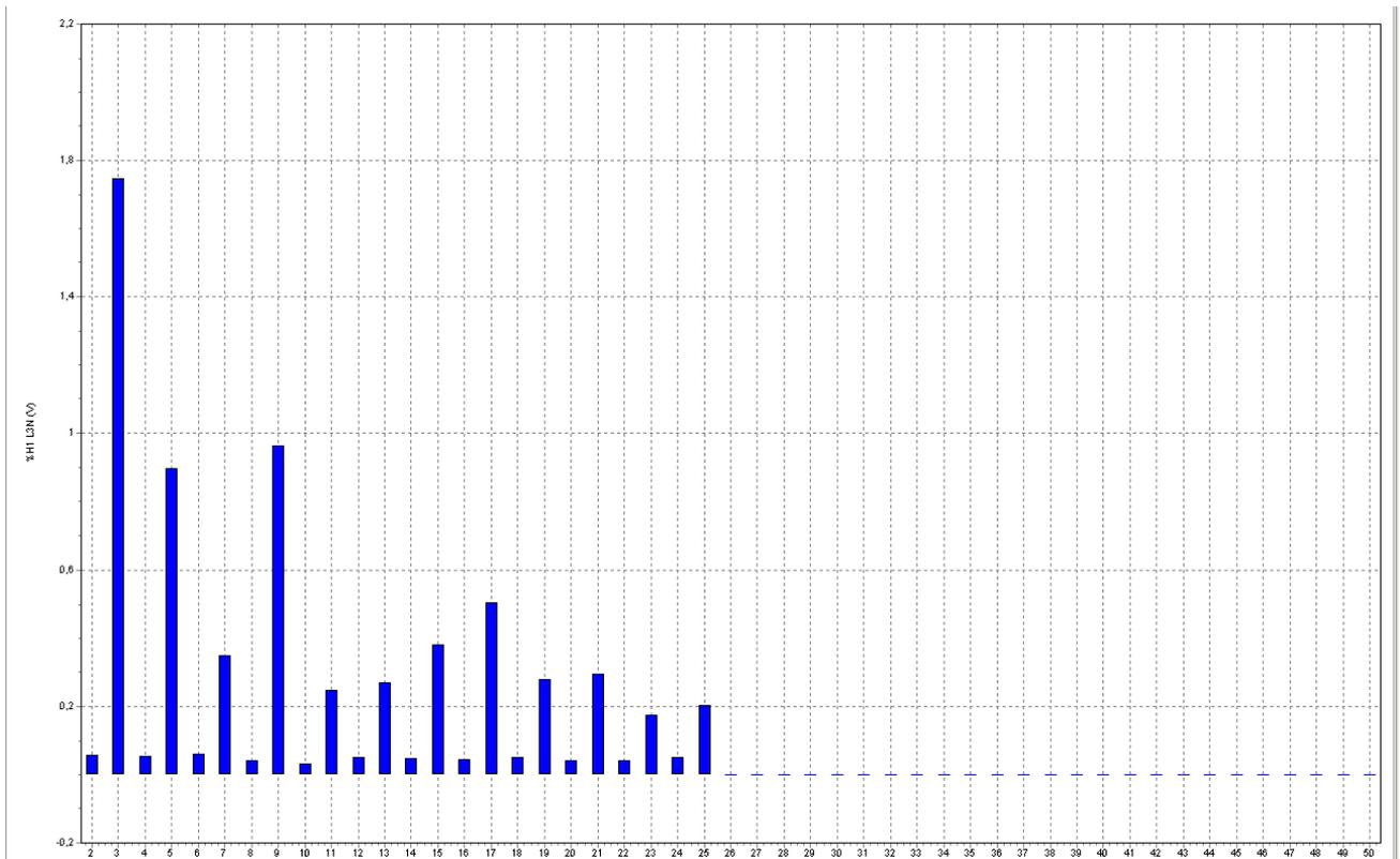
Рис. 1 Гистограмма высших гармонических составляющих напряжения
