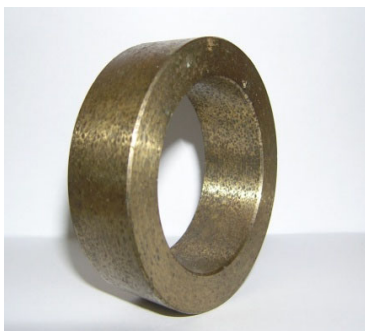
Рисунок 1. Втулка из литого композиционного материала состава «бронза – чугунная дробь»
