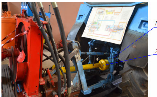
Рисунок 2 – Агрегатирование устройства 1 – заднее навесное устройство трактора; 2 – карданная передача
