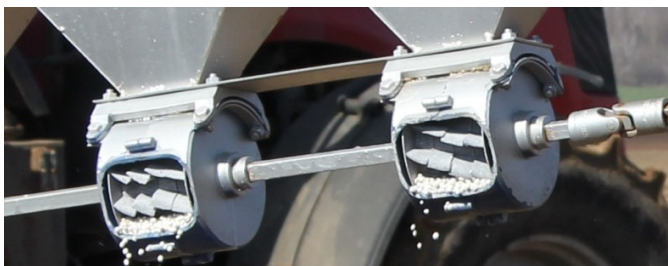
Рисунок 2 – Износ (деформация) желобков дозирующих катушек в РМУ-11000Ш после 50 ч. работы машины.
