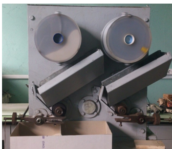
1 – барабан с абразивом; 2 – желоб; 3 – винт; 4 – испытуемый образец; 5 – эластичный ролик; 6 – груз; 7 – держатель
