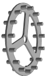
Рис. 3.1. Конструкция кольчато-пруткового почвообрабатывающего рабочего органа
