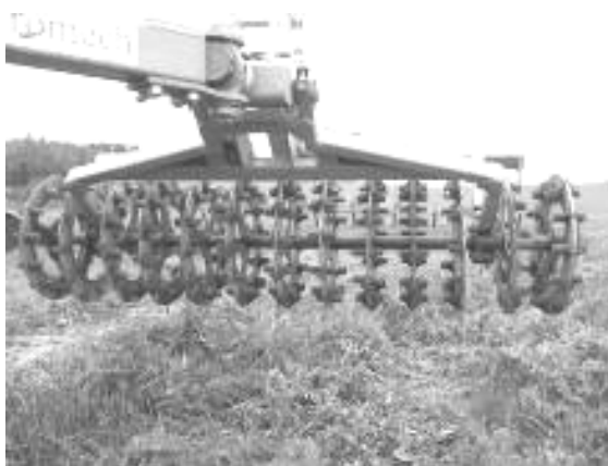
Рис. 6.6. Плуг ПО-(8+4)-40 с тремя катковыми приставками (а) (кольчато-прутковые катки (б))
