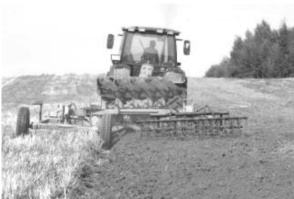
Рис. 6.11. Плуг ППО-5-40 с приставкой на вспашке стерни зерновых
