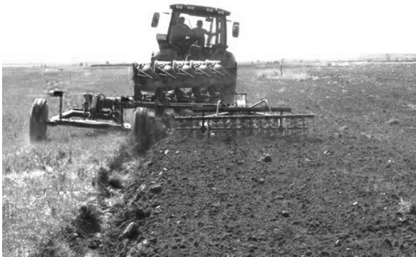
Рис. 6.10. Плуг ППО-5-40 с приставкой на вспашке многолетних трав
