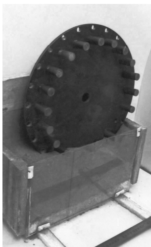
Рис. 3.17. Устройство лабораторной установки для определения формы почвенного ядра: 1 – ящик; 2 – стенка; 3 – фотокамера; 4 – орган рабочий; 5 – ящик; 6 – линейка металлическая; 7 – слой индикаторный
