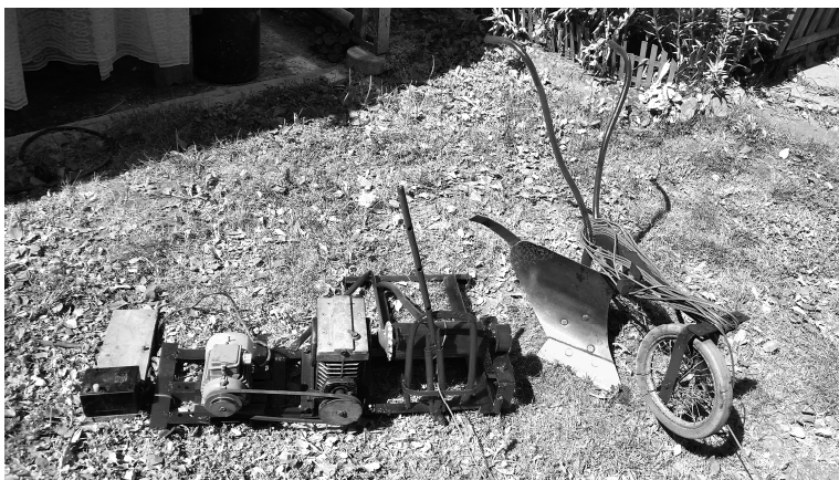
Рис. 5.14. Схема ( a ) и общий вид ( б ) лабораторной установки: 1 – электролебедка; 2 – трос; 3 – камера; 4 – плуг; 5 – слой индикаторный
