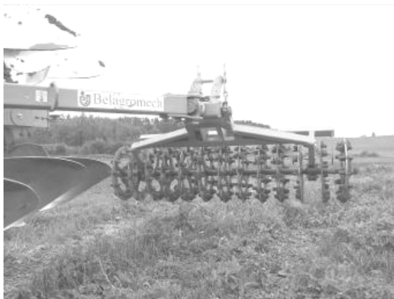
Рис. 6.13. Катковая приставка с кольчато-прутковыми рабочими органами
