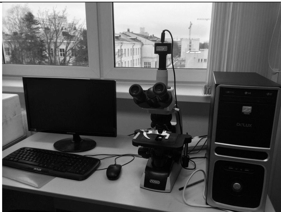
**Рис. 1.** Микроскоп ЛОМО с камерой digital Camera for Microscope DCM310 (USB2/0) 3M pixels, CMOS для оценки размеров пор пивоваренного ячменя
