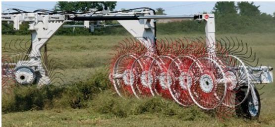
**Рисунок 4. Колесно-пальцевые грабли-валкователи сдвоенного типа**
