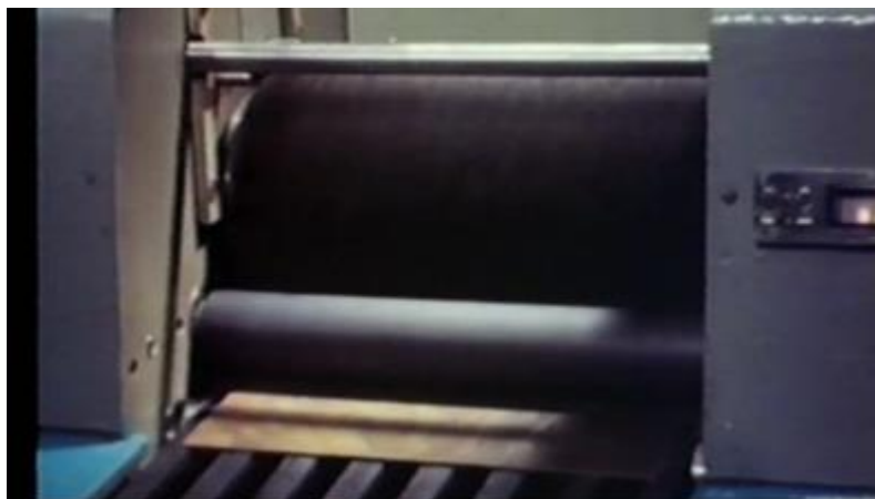
Рисунок 1 - Магнитно-абразивная обработка плоскостей
