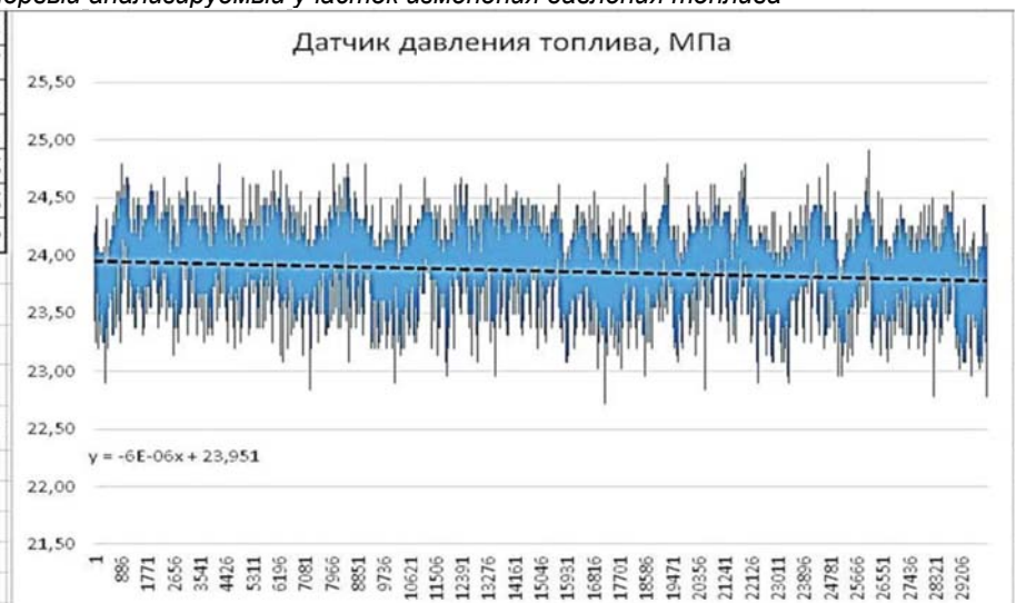
Рисунок 4. Первый анализируемый участок изменения давления топлива
