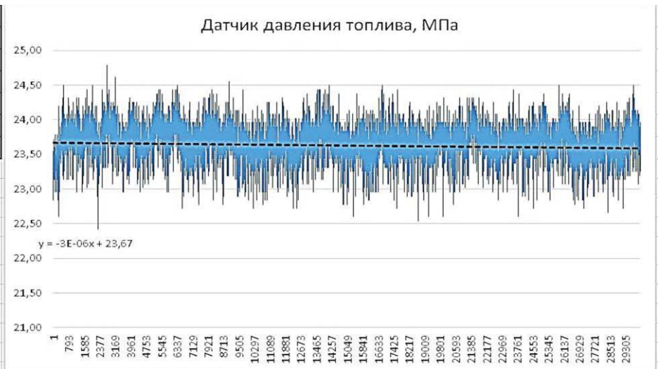
Рисунок 4. Первый анализируемый участок изменения давления топлива
