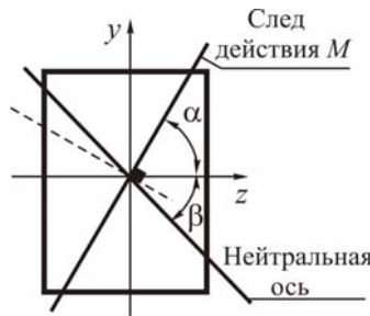
Рис. 4.4. След действия M и нейтральная ось в поперечном сечении бруса
