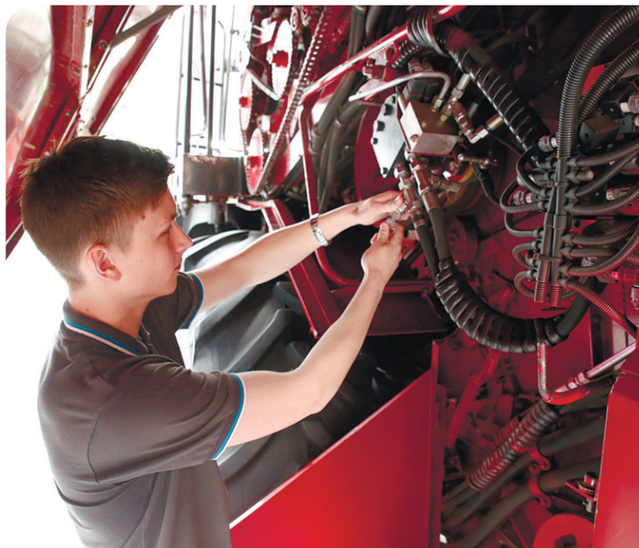
Диагностирование технического состояния гидравлической системы зерноуборочного комбайна «Палессе GS 14»
