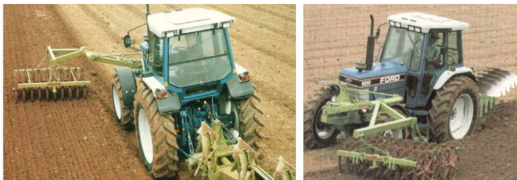
Рисунок 2 – Использование фронтального катка-почвоуплотнителя на пахотном агрегате [1, 3].
