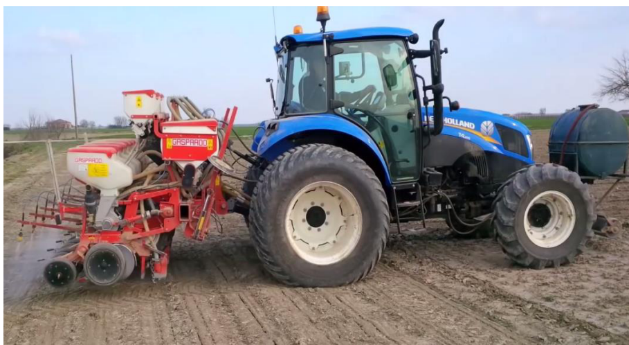
Рисунок 6 – Совмещение основной технологической операции с ленточным внесением рабочих растворов пестицидов.
