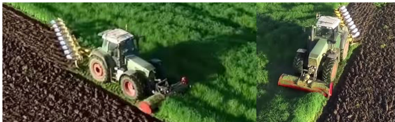
Рисунок 1. – Вспашка покровной культуры с использованием на передней навеске косилки [1,2].
