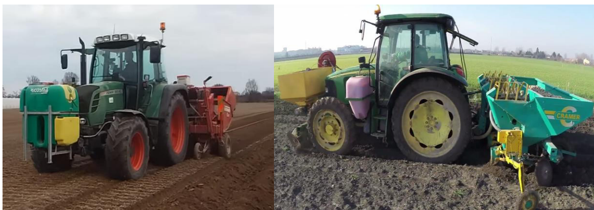
Рисунок 5 – Расположение технологической емкости в составе МТА для посадки картофеля.
