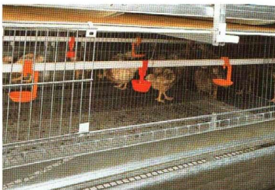
Рис. 9.3. Ярус для цыплят UV-S 630 с открытой круглой поилкой для упрощения поиска воды в первые дни
