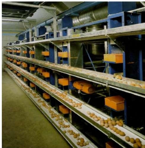
Рис. 9.9. Клеточная батарея кур-несушек Eurovent фирмы Big Dutchman (система сбора яиц)
