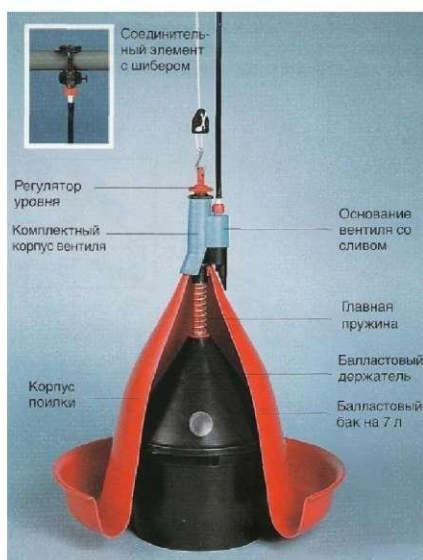
Рис. 9.26. Основные элементы устройства круговой поилки ЮМБО-Т фирмы Big Dutchman
