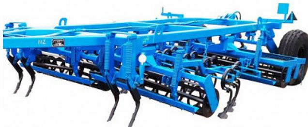
Рисунок 1. – Агрегат предпосевной АП-3 со следорыхлителями
