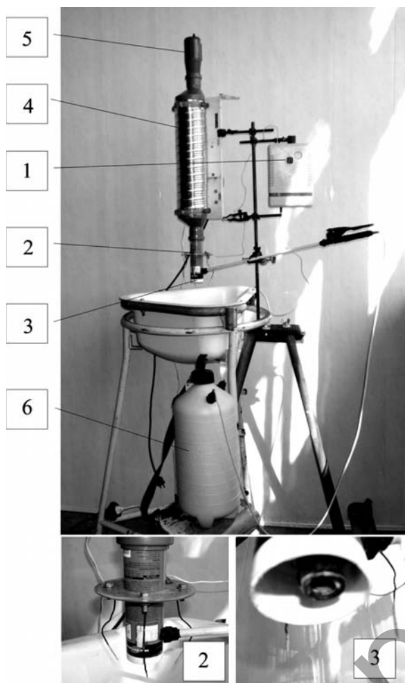
Рисунок 1. Лабораторная установка для исследования процесса электронно-ионного нанесения жидких реагентов на плющенное зерно: 1 – высоковольтный импульсный генератор; 2 – воздушный канал с коронной заострённых электродов; 3 – размещение распылителя в воздушном канале; 4 – корпус озонатора; 5 – проточный вентилятор; 6 – герметичная ёмкость с жидким реагентом.
