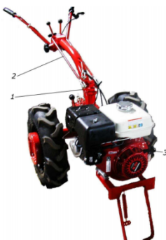
1 – рычаг переключения передач; 2 – тяга механизма переключения передач; 3 – ручной возвратный стартер.
