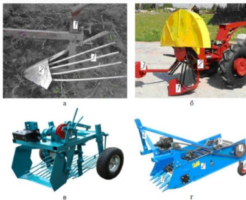
а – копатель-распашник; б – копатель швырального типа; в – копатель-просеиватель; г – копатель элеваторного типа
