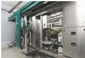
Рисунок 2 – Роботизированная доильная система Mlone
