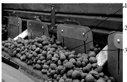
Рис. 17.11. Регулировка положения регулирующей заслонки: 1 – винт; 2 – питатель; 3 – заслонка регулирующая
