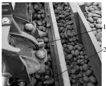
Рис. 17.10. Регулировка уровня заполнения питателей высаживающих аппаратов: 1 – лента ложечная; 2 – питатель
