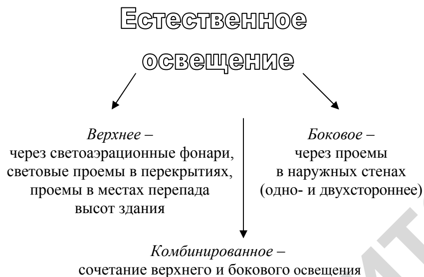
Рис. 7.2. Конструктивное исполнение естественного освещения в помещениях
