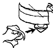
Рис. 8.5. Очистка конуса регулятора
