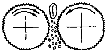
Рис. 4.5. Технологический процесс измельчения скалыванием или крошением
