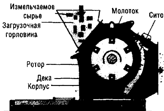
Рис. 25. Схема работы молотковой дробилки
