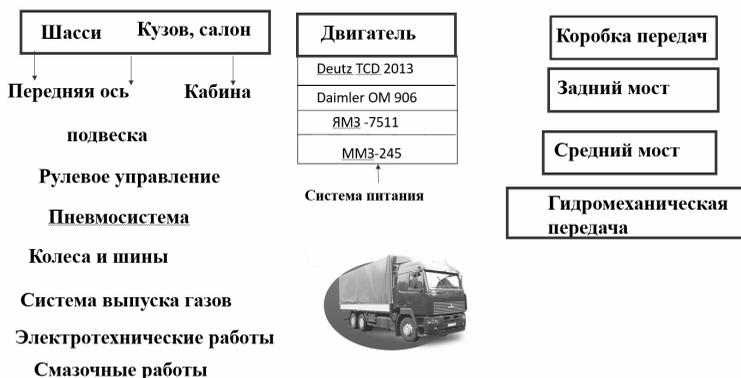
Рисунок 1 – Схема сборки комплектации автомобиля
