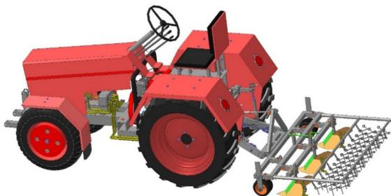
Рисунок 3 – 3D модель малогабаритного комбинированного агрегата
