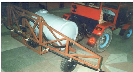
Рисунок 4 – Малообъемный штанговый опрыскиватель
