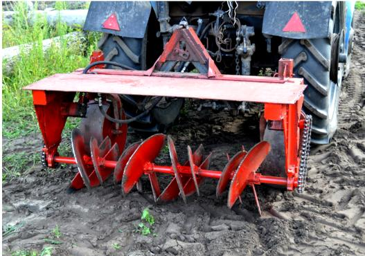
Рисунок 1 – Роторный гребнеобразователь
