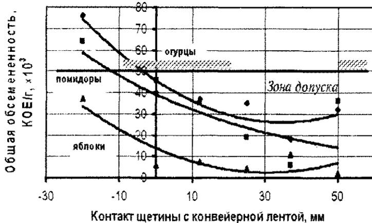
Рисунок 4. Графическое изображение зависимости общей обсемененности плодов после мойки от величины зазора между поверхностью ленты конвейера и ворсом
