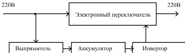
Рис. 3.38. Функциональная схема устройства для бесперебойного питания аппаратуры
