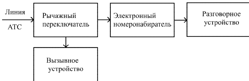
Рис. 4.67. Структурная схема электронного ТА (с кнопочным номеронабирателем)
