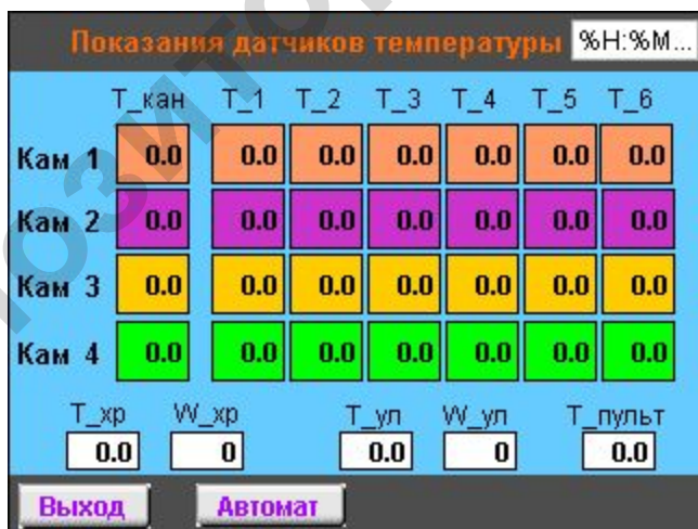
Рисунок 2 – Окно контроля температурных показаний датчиков
