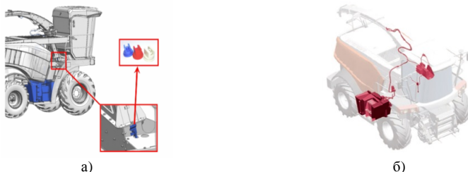
а) место установки в ускоритель распылительной форсунки; б) оборудование с установкой распылительной форсунки на силосопроводе
