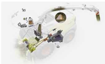
Рисунок 4 – Интегрированная система внесения консервантов на кормоуборочных комбайнах фирмы «CLAAS»
