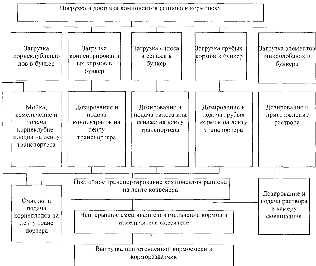
Рис. 1. Общая технологическая схема работы кормоцехов серии КОРК
