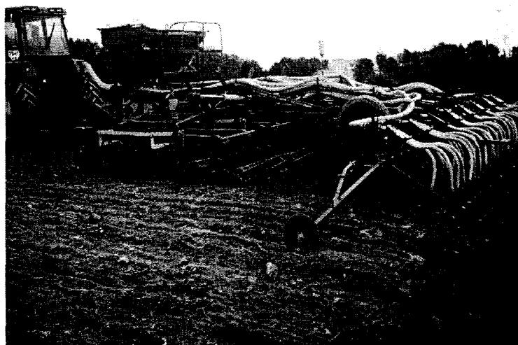
Рис. 2. Комбинированный почвообрабатывающе-посевной агрегат АПП-6 в рабочем положении с трактором «Беларус-1522»
