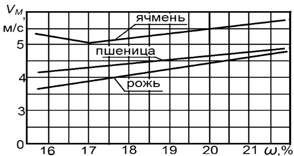
Рисунок 3.5 – Значение допустимой скорости удара планки мотовила по зерну от его влажности
