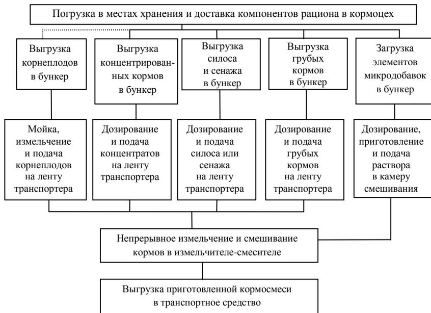
Рис. 2.1. Примерная технологическая схема кормоцеха
