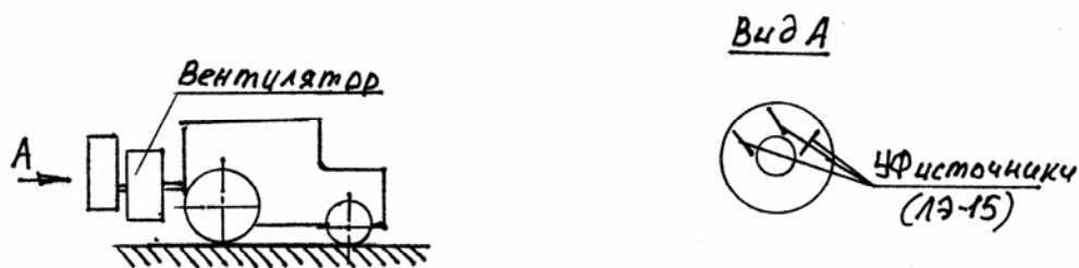
Рисунок 3.11.5 — Схема подвижной установки для борьбы с летающими насекомыми-вредителями
