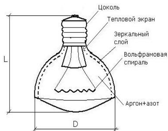
Рисунок 2.1.1 — Устройство лампы типа ИКЗ(К)
