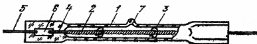
Рисунок 2.1.2 — Общий вид галогенной лампы-термоизлучателя: 1 — кварцевая трубка; 2 — спираль; 3 — вольфрамовые держатели; 4 — вольфрамовые вводы; 5 — выводы; 6 — молибденовая фольга; 7 — штенгель
