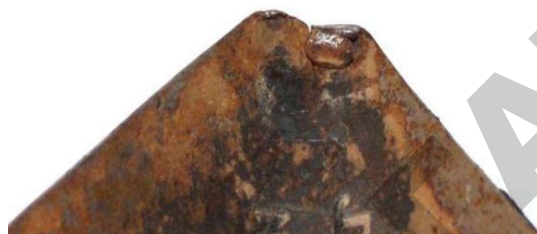
Рисунок 2. Носок культиваторной лапы после изгиба и обламывания
